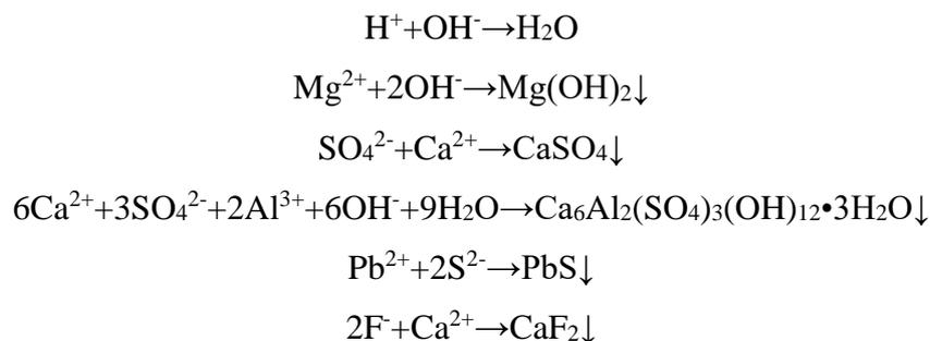
在实际生产过程中要根据实际淋洗水中镁离子、硫酸根离子和重金属离子浓度，动态调整投入的中和沉淀药剂的量。“中和+沉淀”处理废水的工艺，属于成熟技术上，是可行的。
